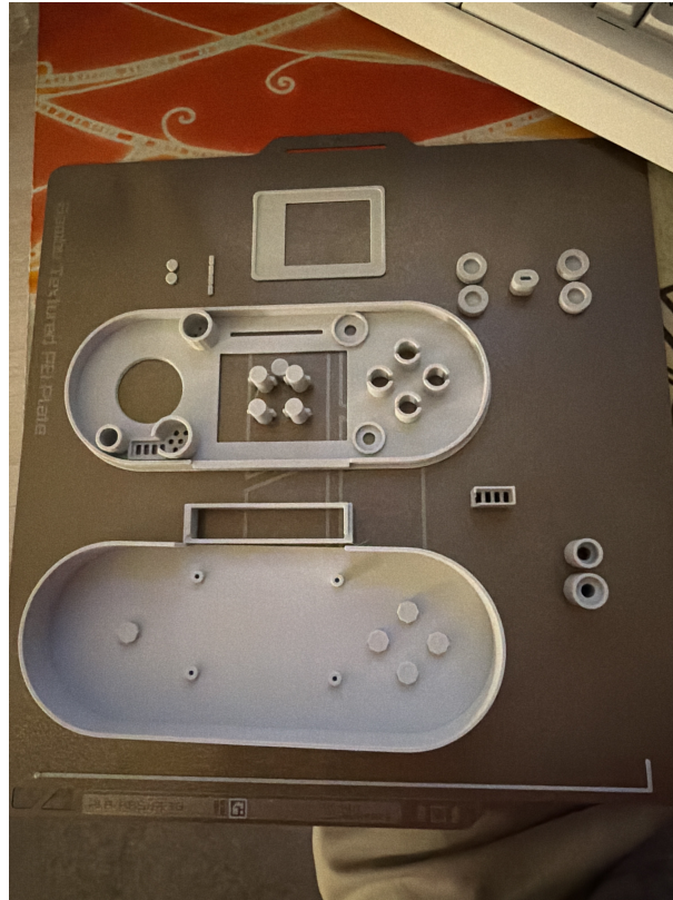
Figure 4.5: Pièces imprimées 3D de la manette (PLA blanc) — vue éclatée sur le plateau d'impression. On distingue les deux coques du boîtier Esplora, les boutons et les entretoises.
