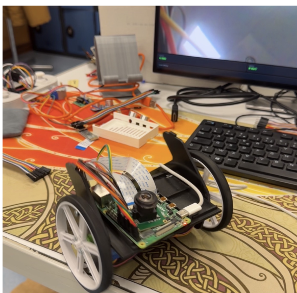
(a) Montage avancé — châssis supérieur posé, Raspberry Pi installé, câblage en cours
